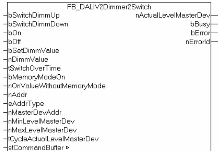
Bild 14: Funktionsblock för styrning av DALI-armaturer[22]
